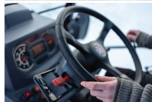
Mechanická převodovka s reverzační pákou Power Shuttle u model MF 1700 M-12Fx12R pro maximální pohodlí při každé činnosti.
